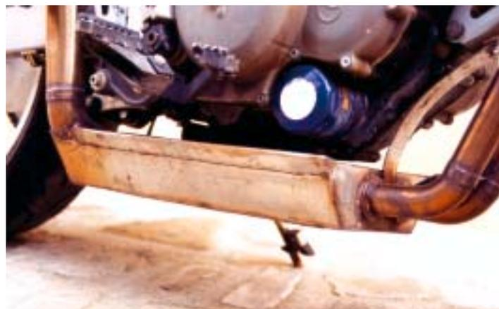
Il dettaglio del grosso volume di "plenum" ricavato sotto il carter motore.
