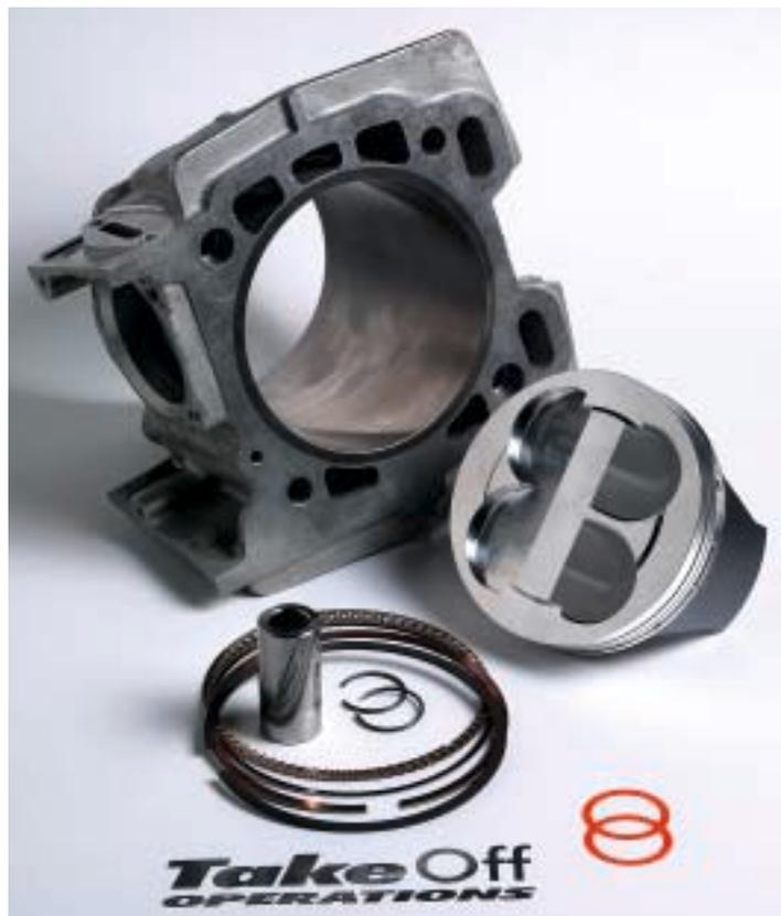
*Le sperimentazioni sui mono Gilera sono solo all'inizio: assieme ad altri appassionati il signor NordWest ha realizzato camme dalla fasatura decisamente più spinta, pulegge regolabili per una messa a punto fine e questo kit che, con un pistone stampato del diametro di 102,4 mm, porta la cilindrata a 610 cm<sup>3</sup>... ne vedremo delle belle!*
