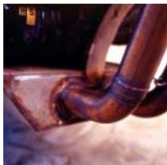
I collettori, come il resto della marmitta sperimentale, sono stati realizzati esaltando al massimo la praticità di costruzione e di utilizzo. Per evitare il problema di saldare di testa tubi in acciaio inox di spessore molto sottile, sono stati usati degli anelli da sovrapporre alle giunzioni e quindi saldare alle estremità senza rischiare colature o soffiature.
