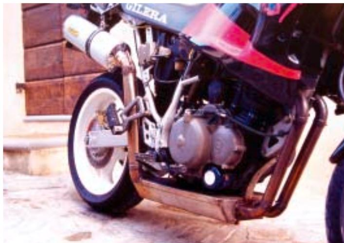
Ben visibile nel dettaglio la "vasca", del volume di 6 litri; se confrontato con la versione originale l'andamento dei collettori primari appare ben più rettilineo.
